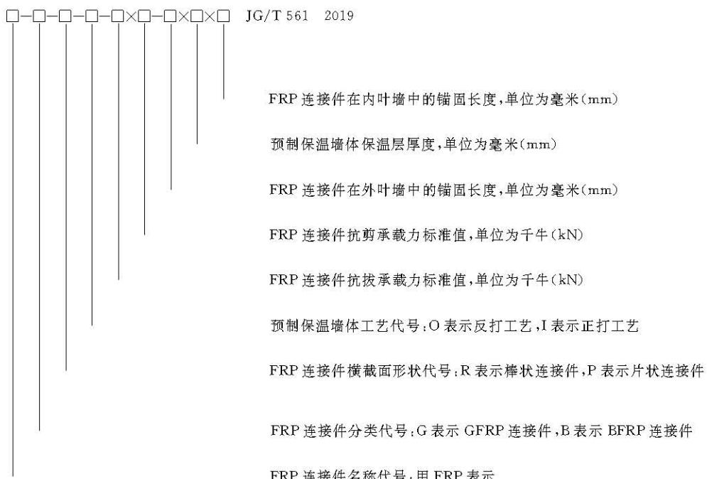
示例:采用 GFRP 材料,横截面形状为棒状,适用于采用反打工艺制作的预制保温墙体,抗拔承载力标准值为 7.2 kN、抗剪承载力标准值为 2.8 kN,在内叶墙中锚固长度为 30 mm、保温层厚度 50 mm、在外叶墙中锚固长度为 30 mm,执行本标准的 FRP 连接件,标记为:FRP-G-R-O-7.2×2.8-30×50×30 JG/T 561 2019。对应的连接件构造示意见图 1。
